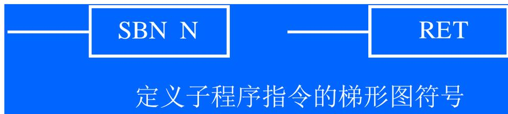
**SBN N**表示子程序的开始，**N**是子程序编号，范围为**00~49**。**RET**表示子程序的结束。在一个程序中，每个子程序占用一个独立的子程序编号，编号不能重复。**PLC**总是把第一个**SBN**前面的程序认为是主程序。子程序的编程方法与主程序相同。
