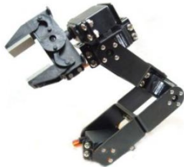
一种平面两自由度刚性机械臂
